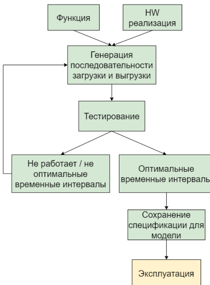
Рисунок 10 – Алгоритм генерации спецификации ВБ
